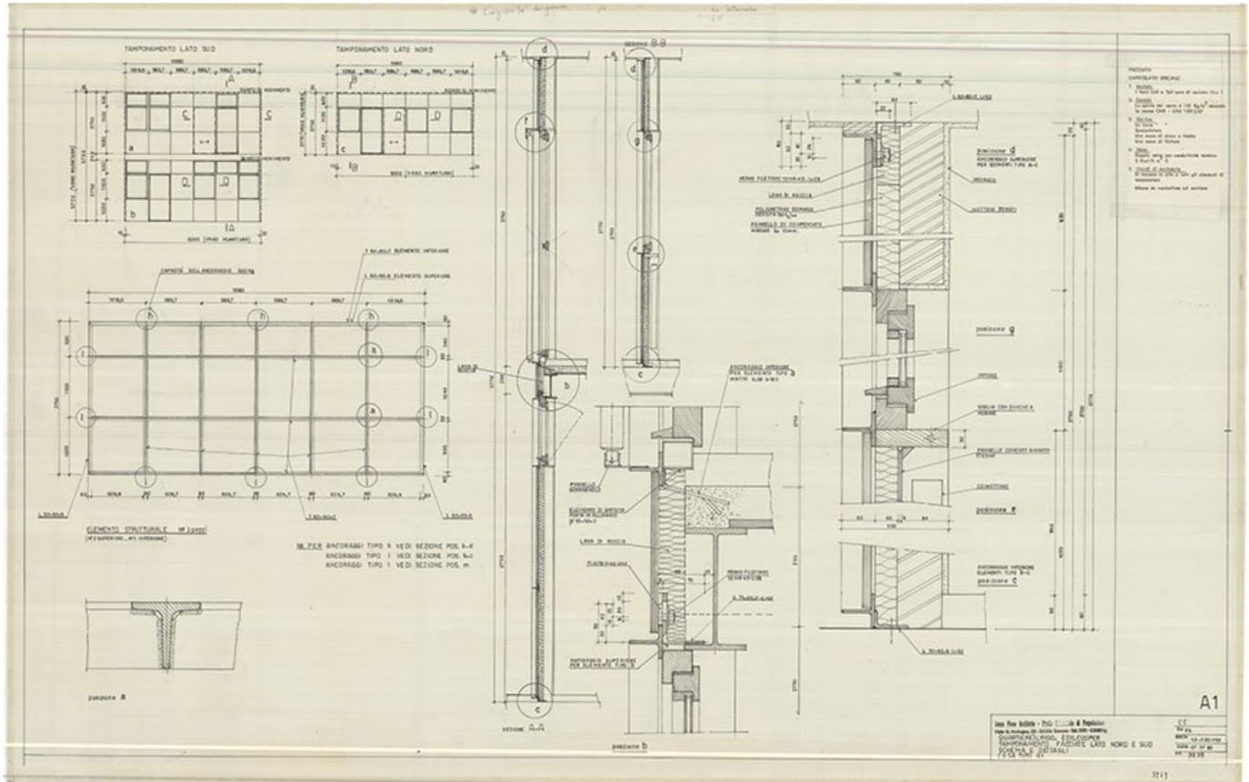
**TITOLO** Tamponamento facciate lato Nord e Sud (casa tipo A1) - schema e dettagli
